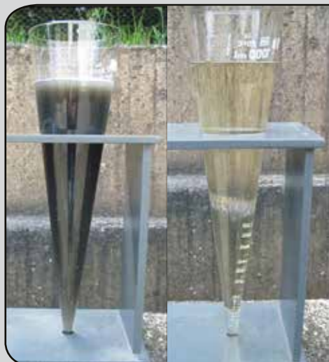
Watermonster van onbehandeld grijs water en van water na behandeling met een GEP membraanfilter.
